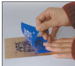
8 - Laissez refroidir ou passez sous l'eau froide et détachez le support PnP-blue de la face cuivrée du circuit.
